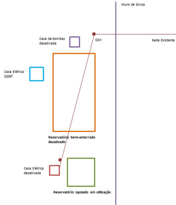
Figura 7 - Esquema de reservação existente na área de intervenção (meramente ilustrativo)
