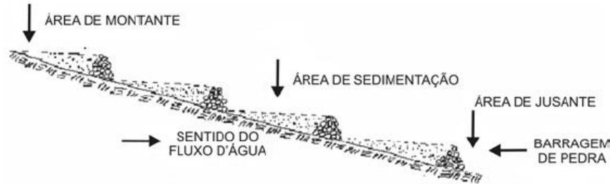
Figura 6.21 - Sequenciamento de barramentos
