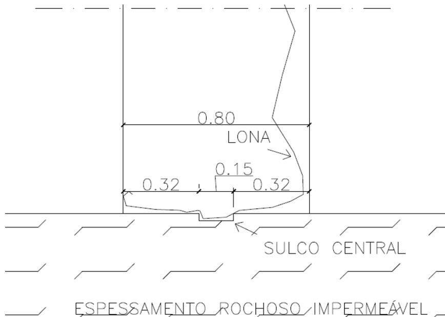
**Figura 6.15 - Detalhe do sulco central no fundo da barragem subterrânea**
