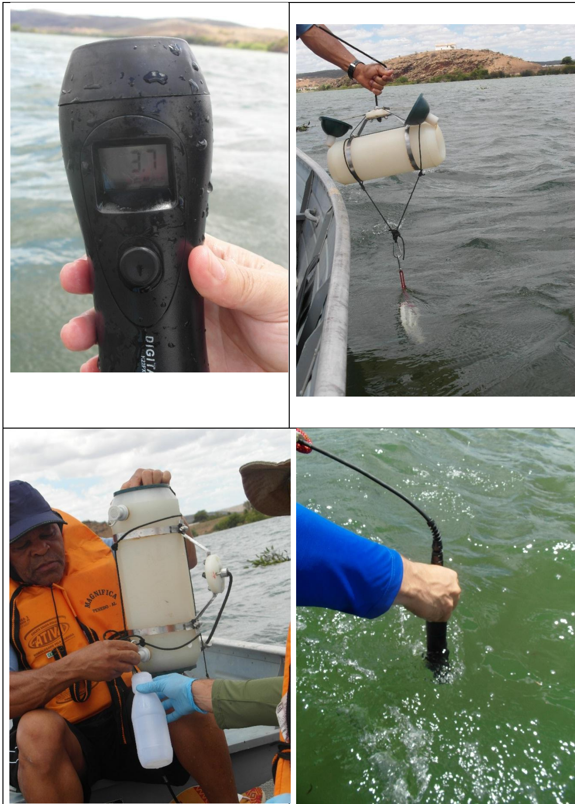
Figura 3. Procedimentos de coleta de amostras de água e medição na II Expedição do Baixo Rio São Francisco em novembro de 2019.
