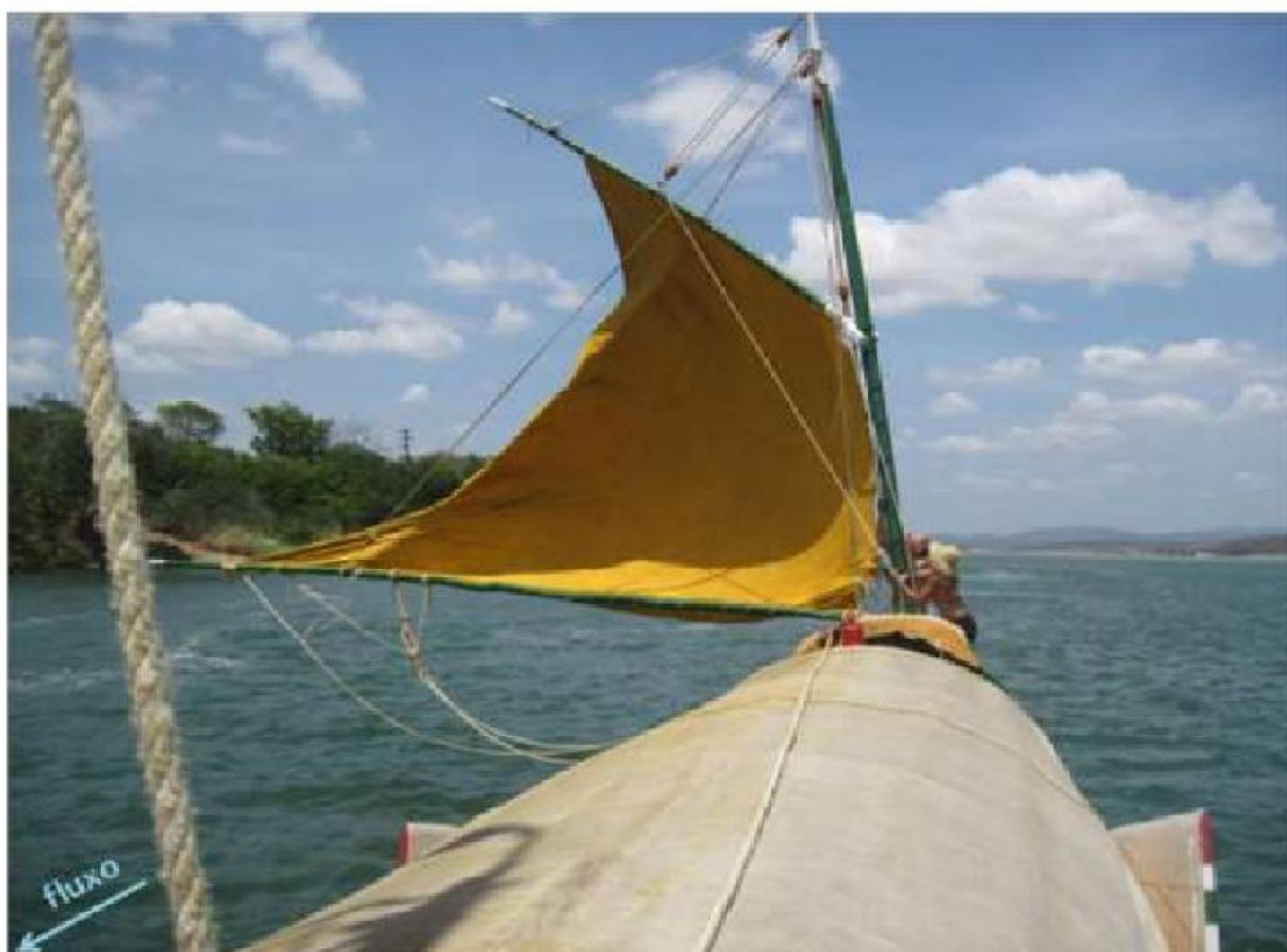
Foto 078 - No través da Fazenda Esperança, a jusante de Gararu, o abafamento do traquete de proa para redução da velocidade e diminuição de riscos de impacto em croas. A canoa Luzitânia não é segurada.
