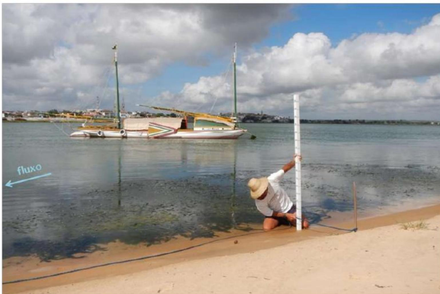
Foto 027 – Medição da variação (nível local) da lâmina d'água em função da operação de Xingó. A régua é graduada de 100 em 100 milímetros – 1,70 m de altura. Valor obtido nesta tomada: cerca de -185 mm (valor negativo).
