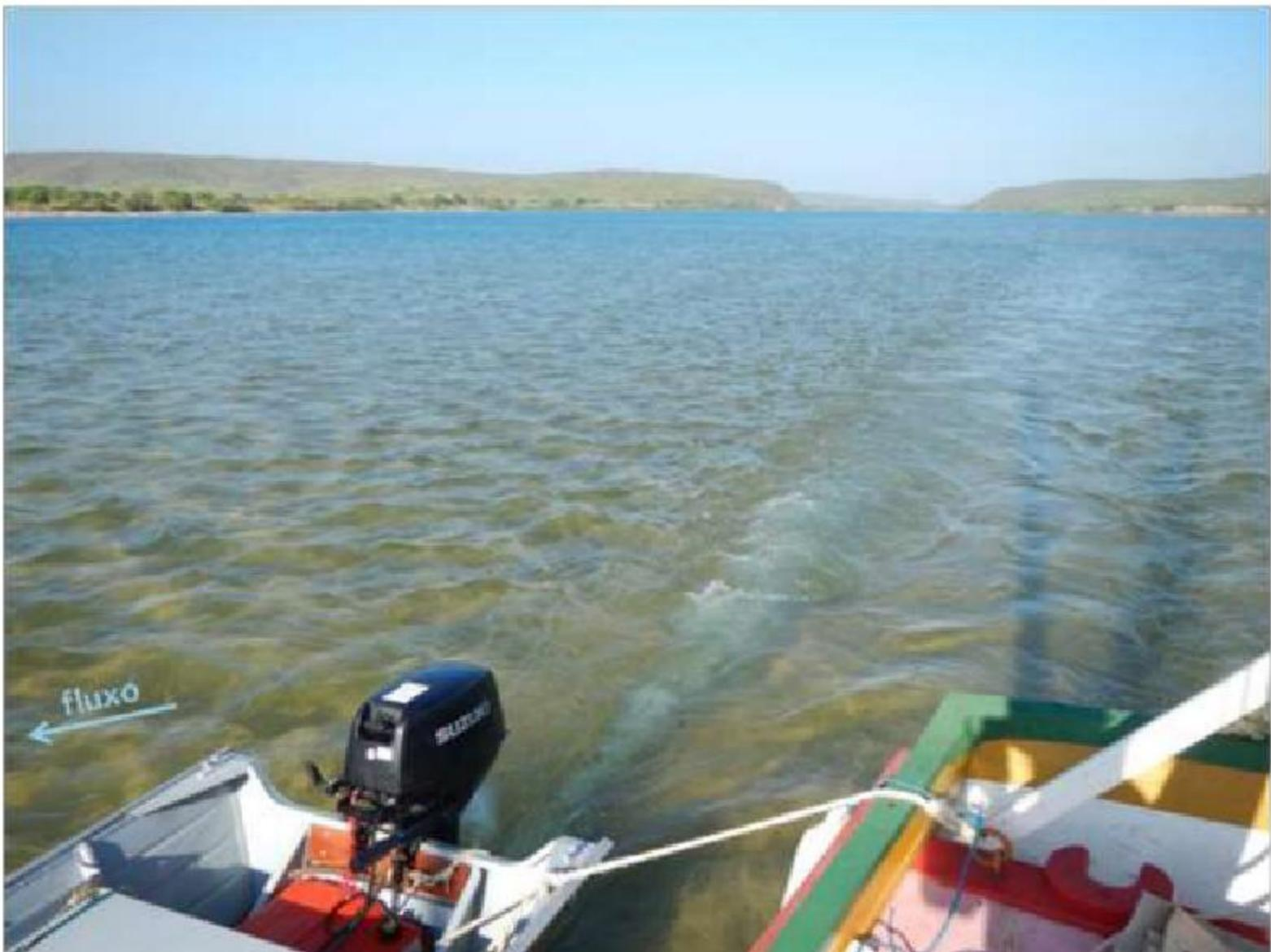
**Foto 145 – A rabeta do motor da embarcação de reboque – cala cerca de 50 cm – tem uma margem de folga mínima até o fundo do rio. É a comprovação da impossibilidade de navegações de longo curso por embarcações maiores. Por onde passaram vapores e grandes canoas.**
