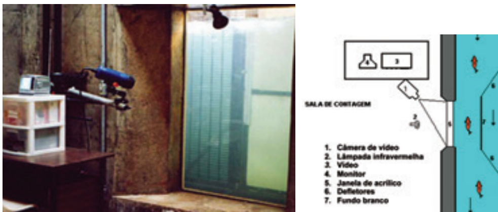
FIGURA 3 – Sala de contagem da EPI: fotografia da sala de contagem; o sistema de registro de imagens, com a câmera e o videocassete (acima); a janela de acrílico transparente (à direita e ao fundo); a lâmpada infravermelha (no topo da janela). Esquema do trecho da escada (acima); sala de contagem (acima). Fonte: Vono et al., 2004.
