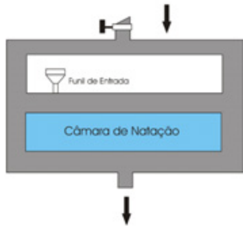
FIGURA 6 – Aparato desenvolvido por Bishai em 1960. FONTE: Adaptado de BEAMISH, 1978. p. 124
