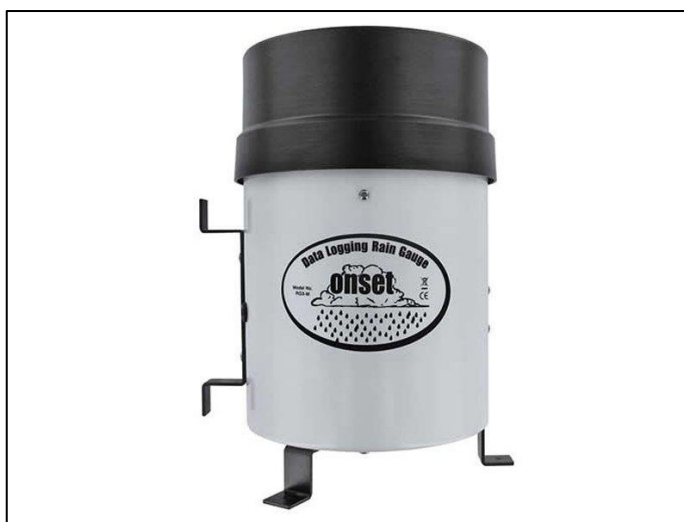
Figura 21- Pluviômetro Digital para medição de chuva
