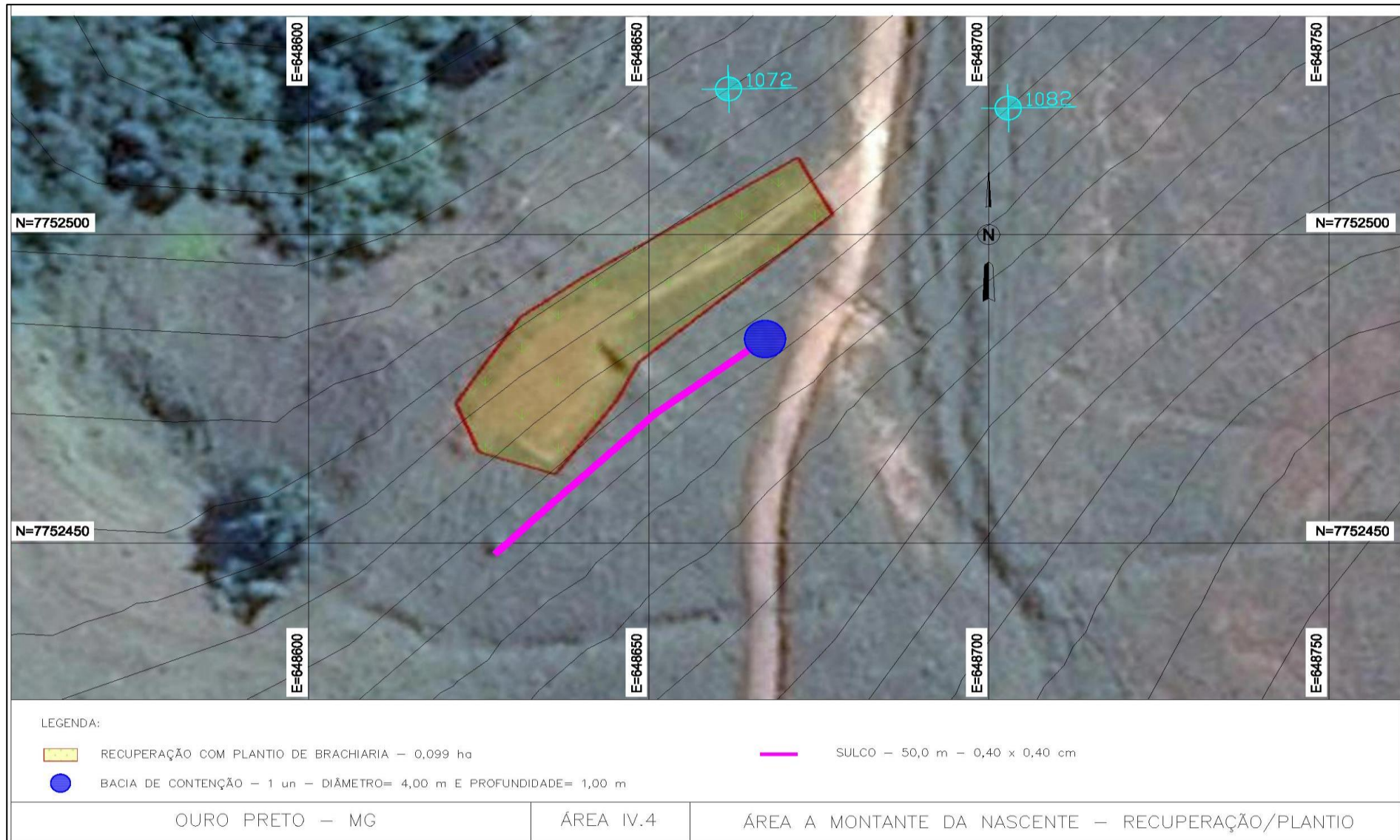
Figura 6.36 – Área de terraplanagem a ser recuperada
