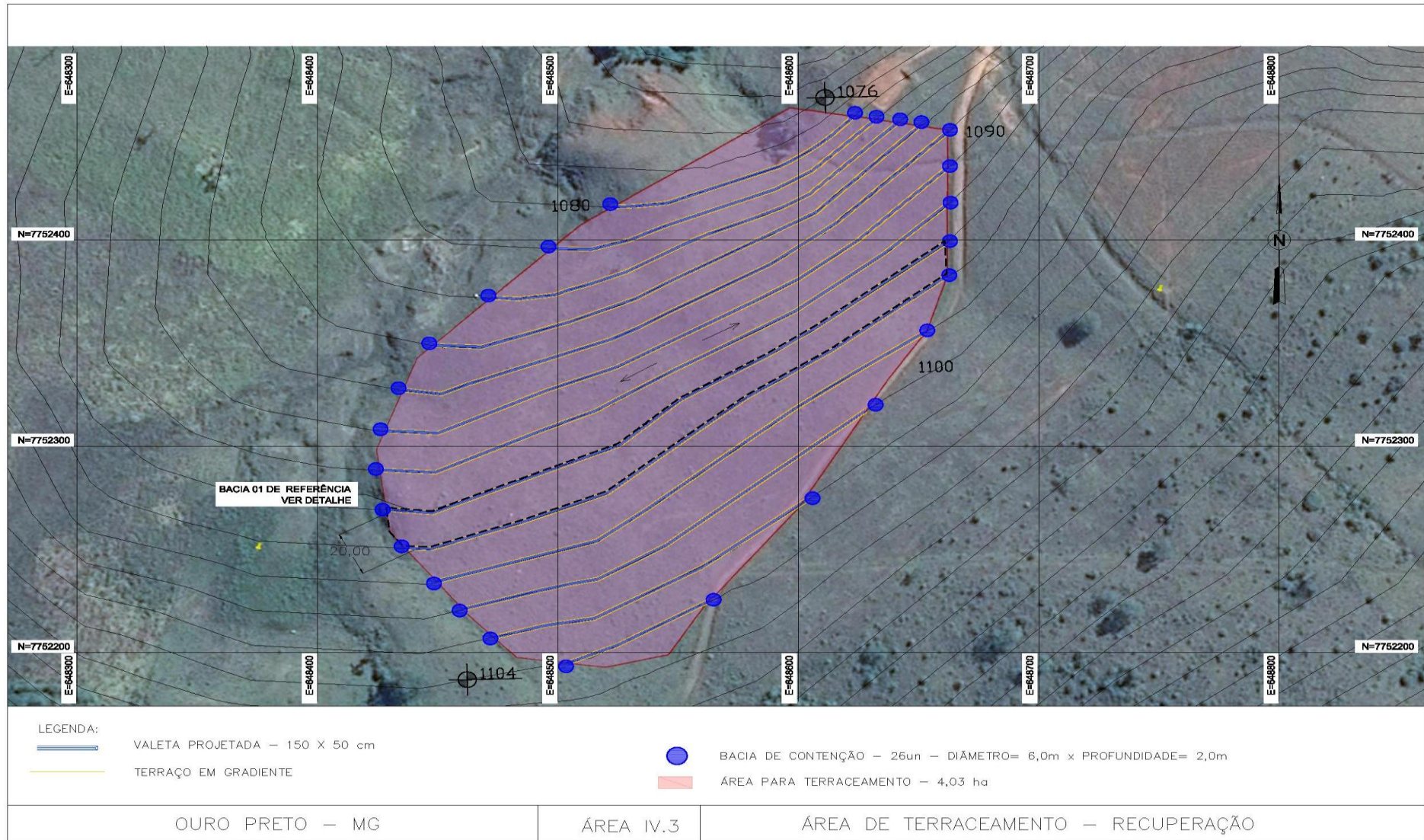
Figura 6.32 – Projeto de recuperação – terraceamento
