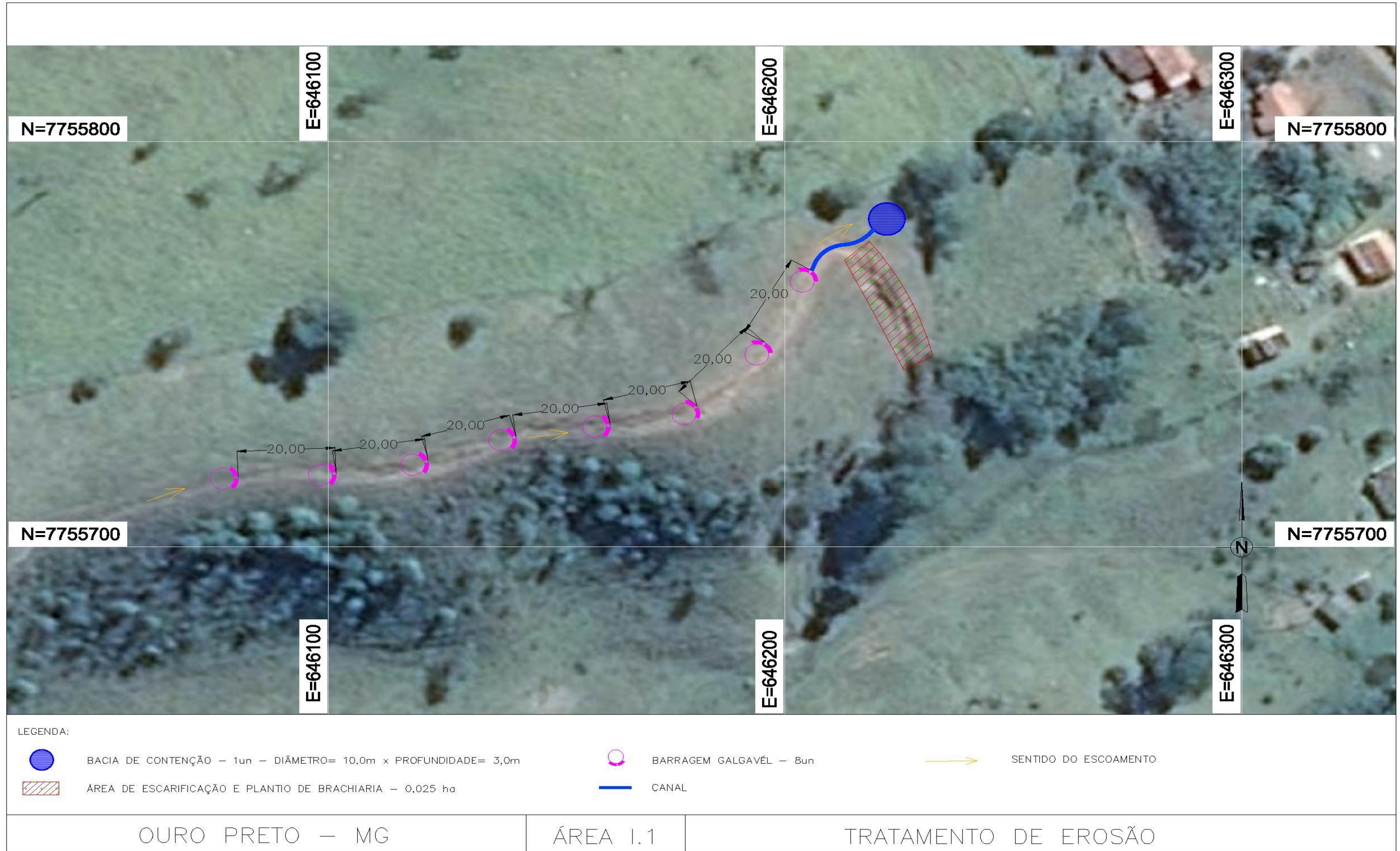
Figura 6.6 – Projeto de recuperação de processo erosivo
