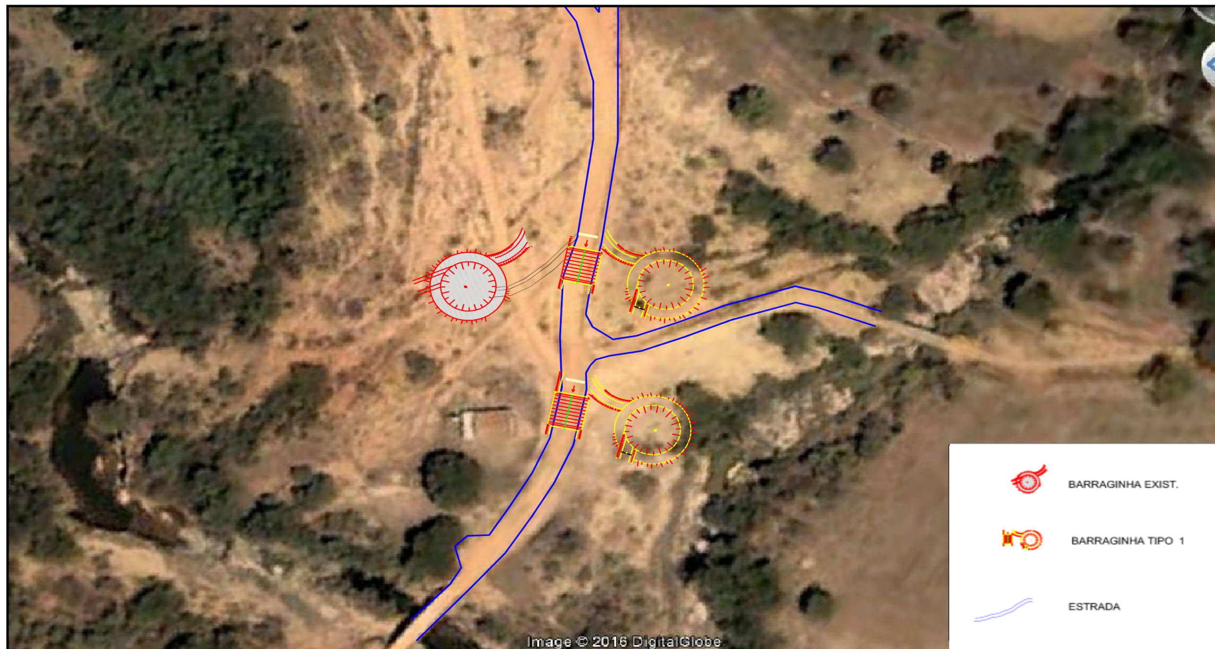
Figura 25: Locais indicados para execução de barraginhas tipo 1 e bigode conectado à barraginha existente
