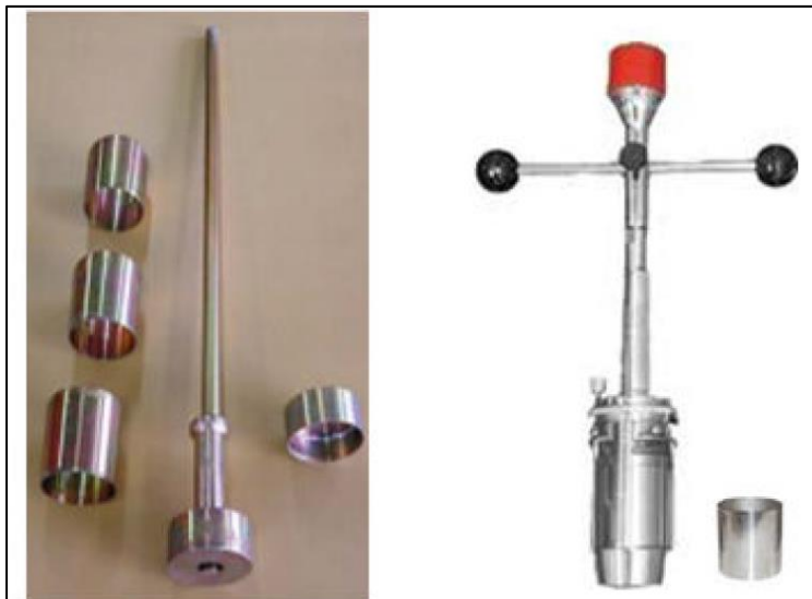
Figura 8.2 – Equipamentos utilizados para coleta de amostra indeformada
