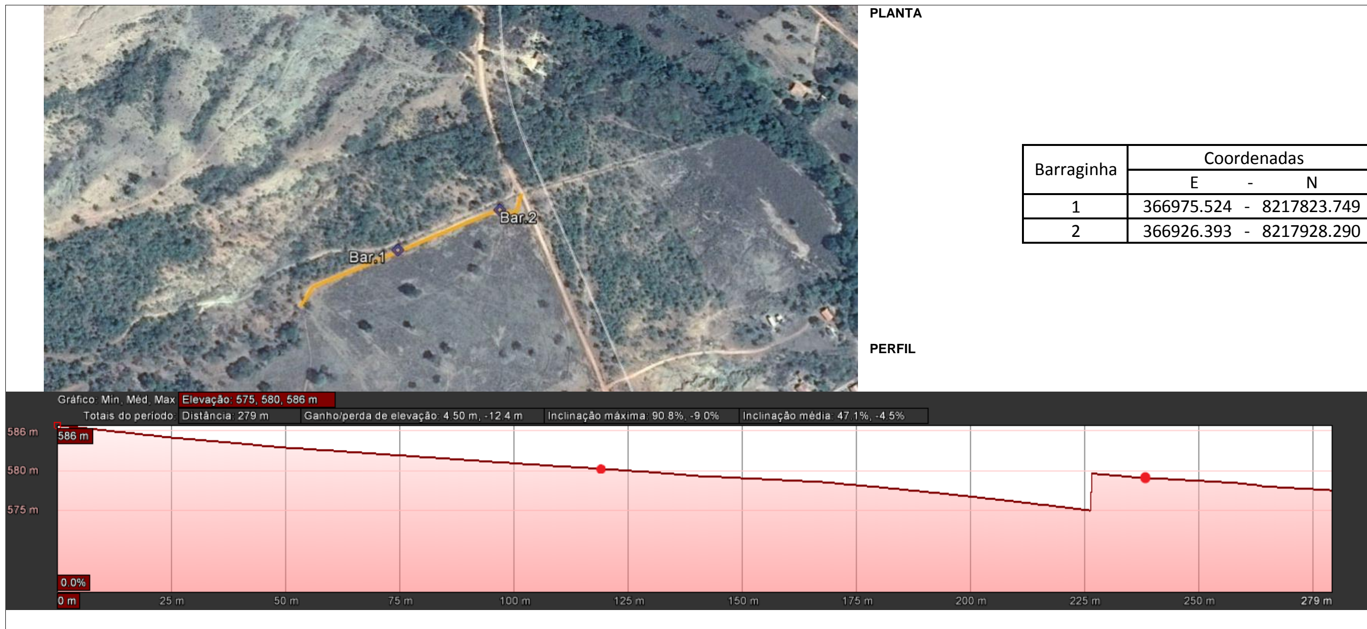
Figura 7.21 – Trecho 17 de readequação de estrada – Área III
