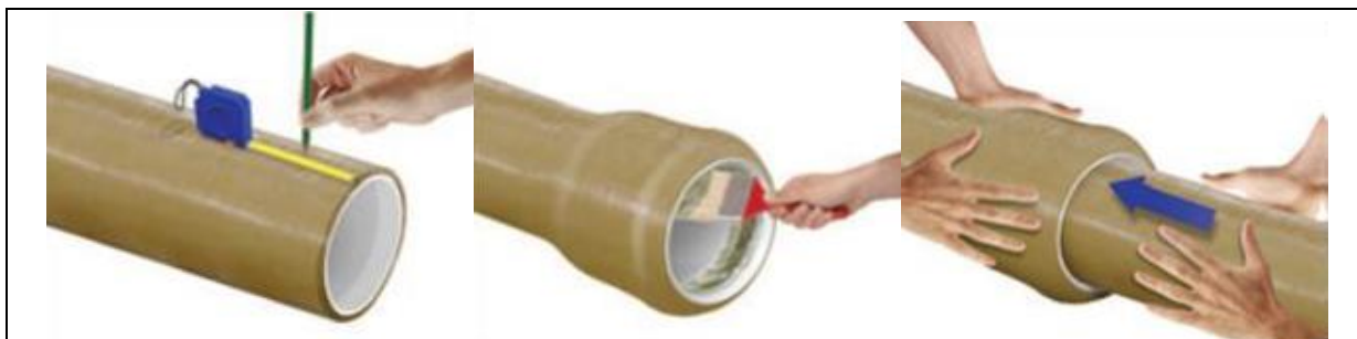
Figura 11.4 - Exemplificação da montagem dos tubos da adutora de água bruta.
