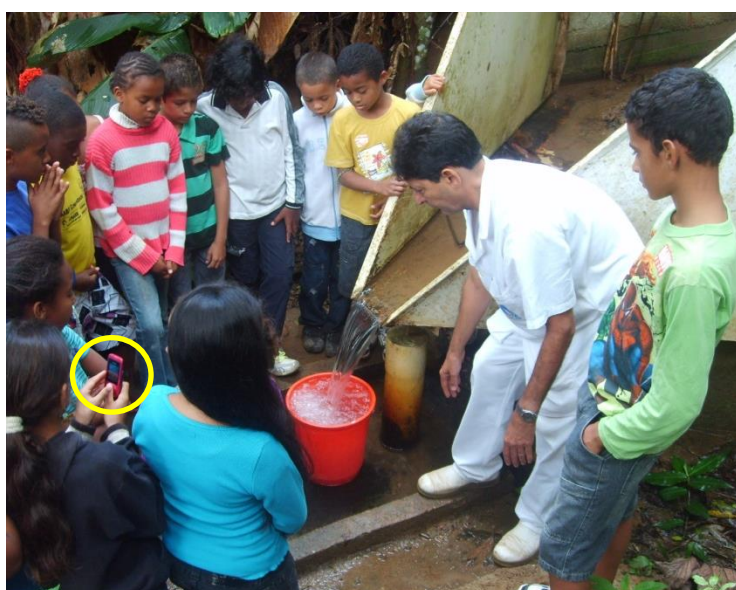
Figura 8.2 - Procedimento de medição de vazão em pequeno curso d'água através do método direto (Fonte: SAAE Viçosa, 2011).
