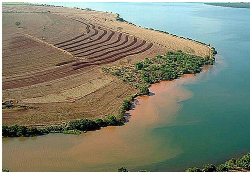
**Figura 22 - Contraste da elevação da turbidez provocada pela defluência de contribuinte com elevada quantidade de sedimentos.**
