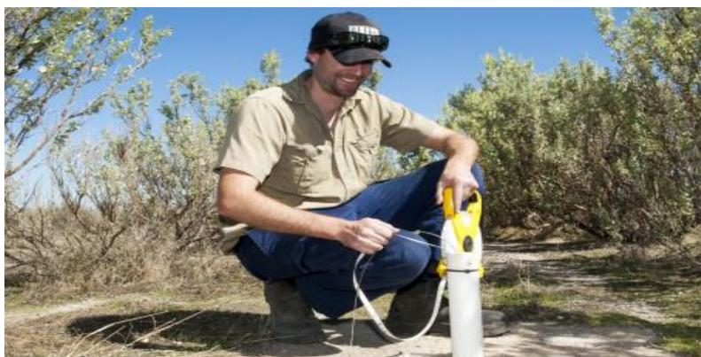
**Figura 21 - Exemplo de monitoramento de nível freático em local de clima semiárido, na Austrália.**
