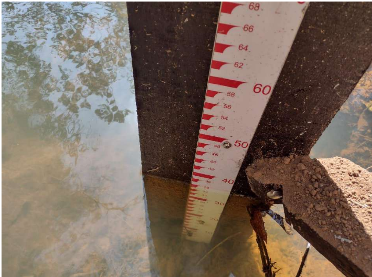
Figura 5.11 – Medição do nível d'água com a régua linimétrica
