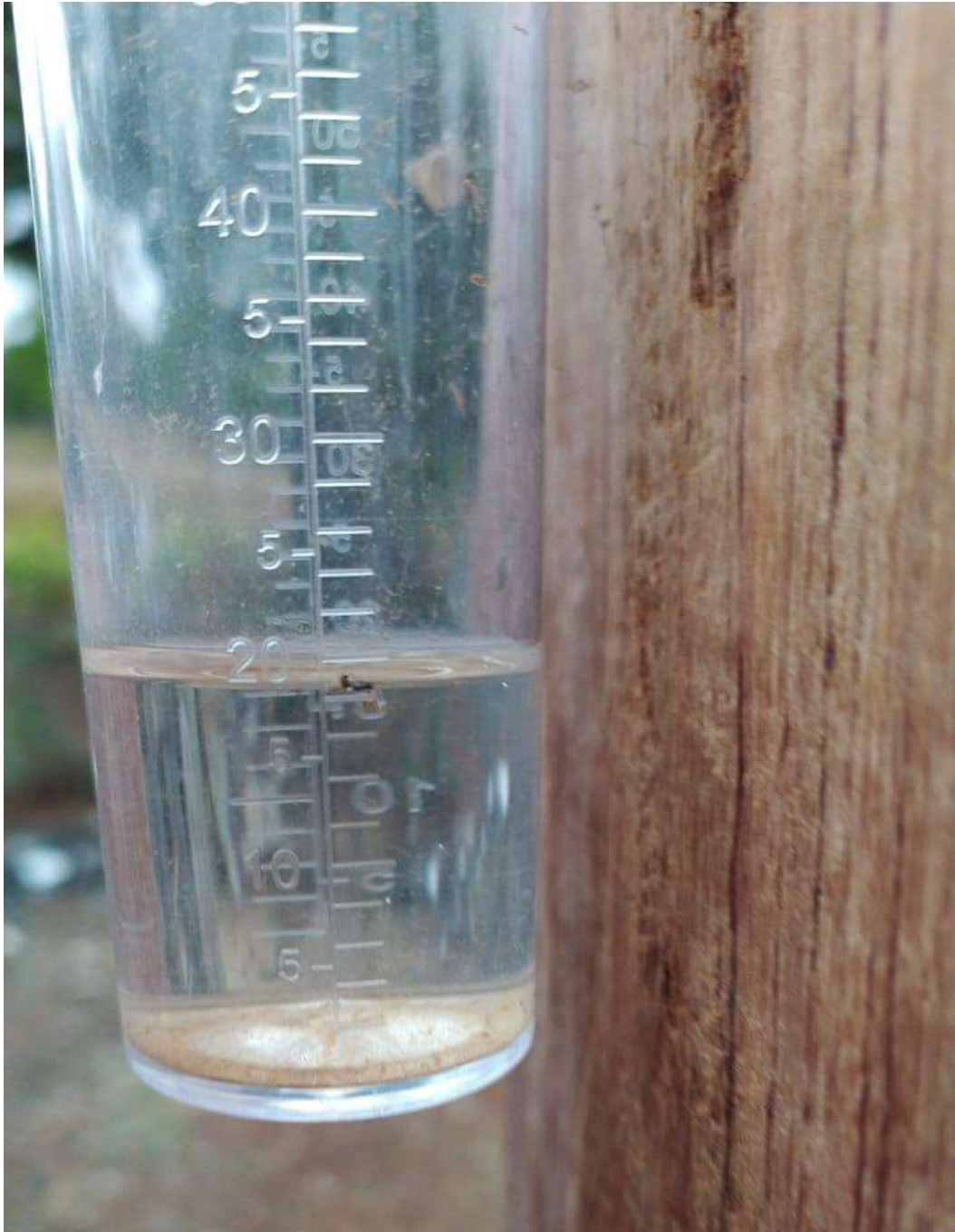
Figura 5.4 – Pluviômetro com água acumulada em condição de medição
