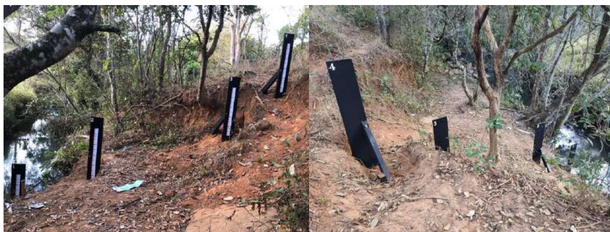
Figura 5.10 – Réguas linimétricas instaladas no Ribeirão dos Custódios, em Cláudio/MG
