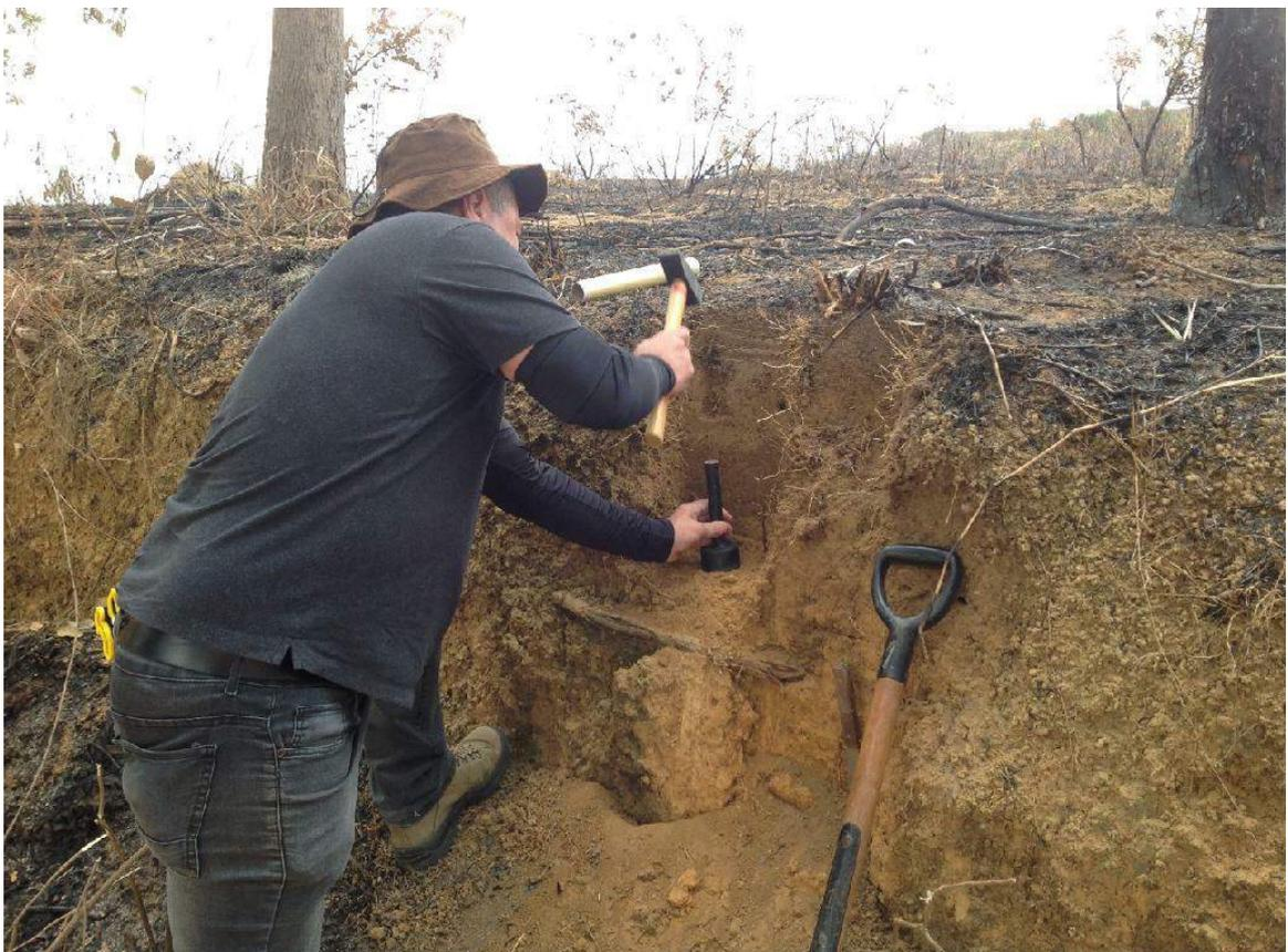
Figura 4.7 Coleta de amostras indeformadas com anéis no PONTO 8.
