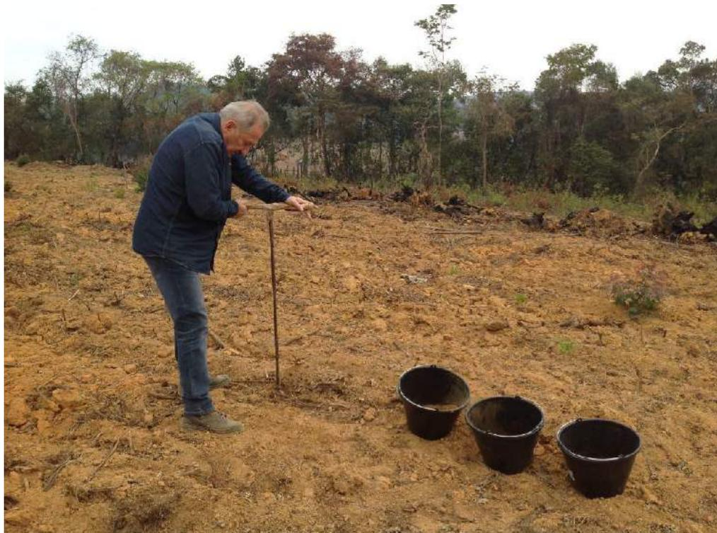
Figura 4.26 Coleta de amostras para análises físico-químicas.
