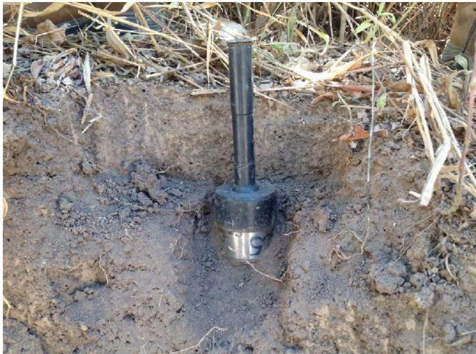
Figura 4.57 Coleta de amostra indeformada no PONTO 54.
