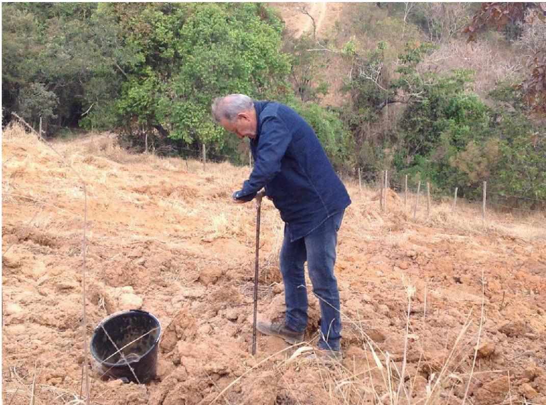
Figura 4.88 Coleta de amostras para análises físico-químicas com trado holandês.
