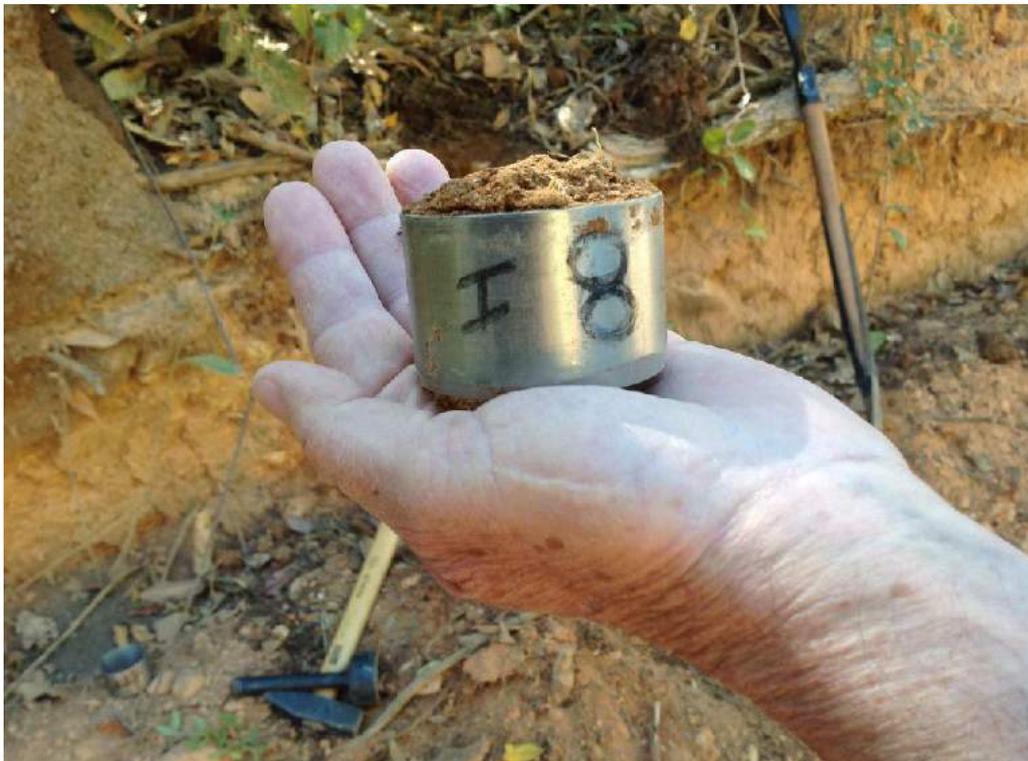
Figura 4.96 Anel volumétrico coletado com amostra indeformada.
