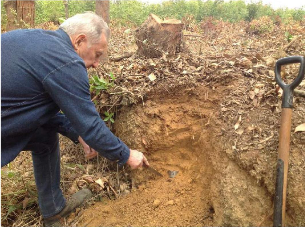
Figura 4.13 Coleta de amostras indeformadas com anéis no PONTO 17
