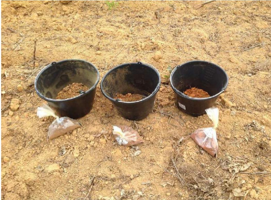
Figura 4.27 Amostras de solos em três profundidades coletadas e ensacadas.
