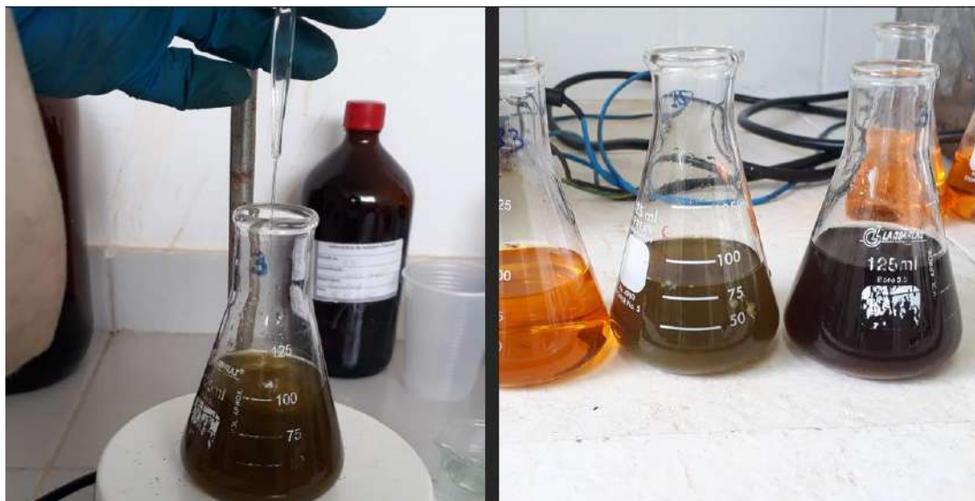
Figura 4.4 – Determinação de Carbono orgânico por oxidação via úmida
