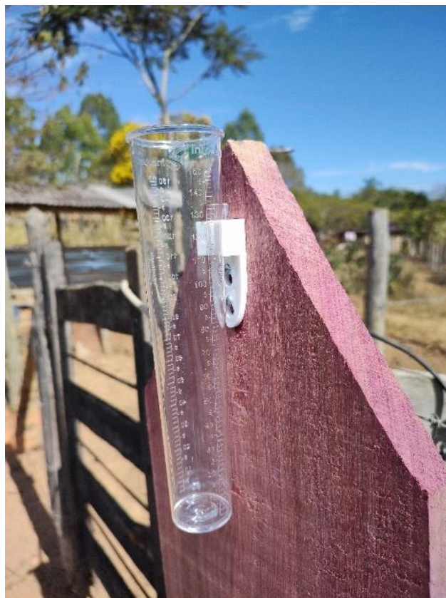
Figura 5.3 – Pluviômetro acoplado a uma tábuia de madeira de lei (roxinho)
