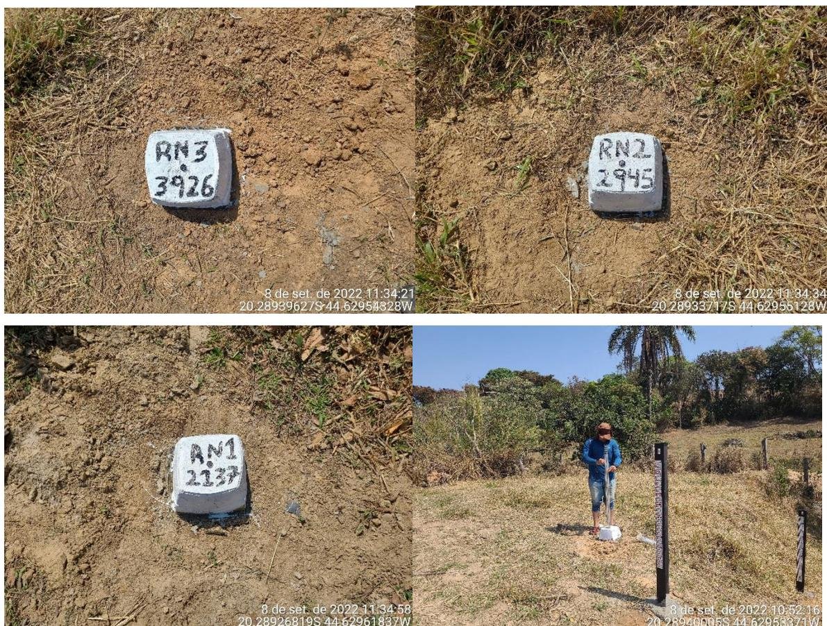
Figura 3.10 Instalação dos RNs na seção monitorada da microbacia do Ribeirão do Sapé.
