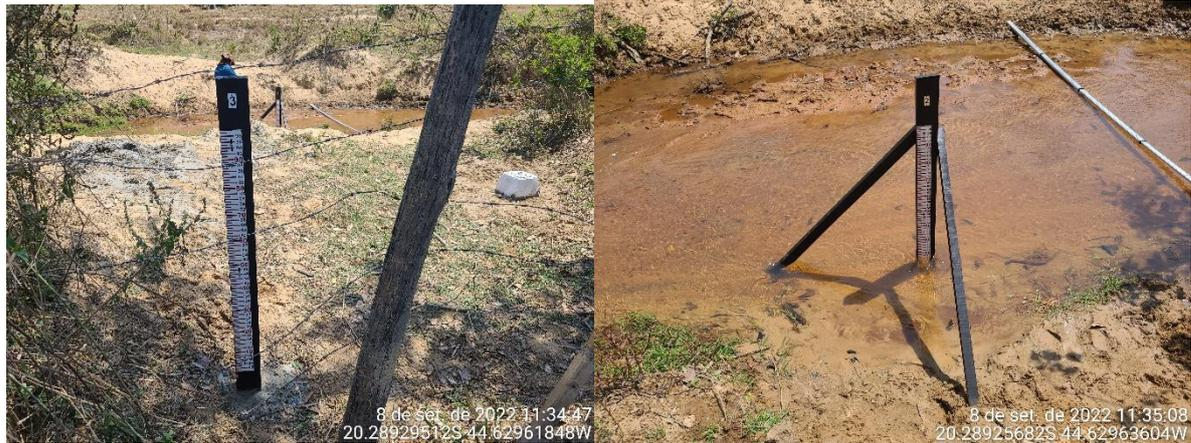
Figura 3.12 Seção de réguas linimétricas instaladas.
