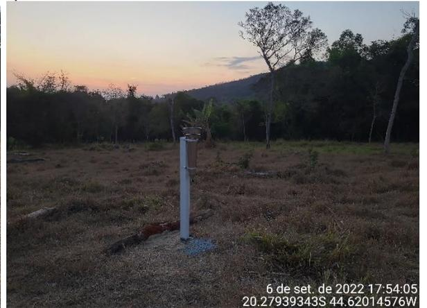
Figura 3.4 Instalação do pluviômetro Ville de Paris
