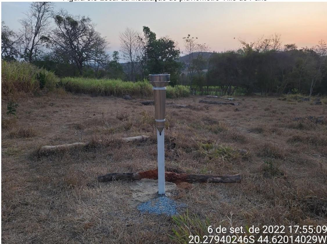
Figura 3.6 Instalação do pluviômetro Ville de Paris
