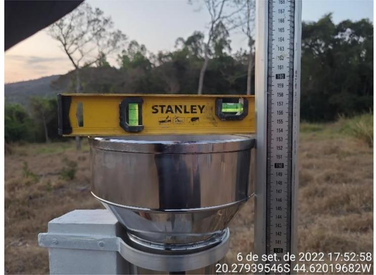
Figura 3.3 Instalação do pluviômetro Ville de Paris
