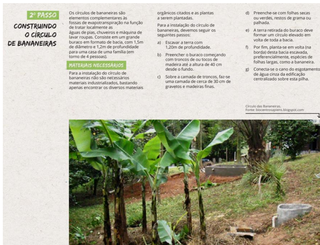
Figura 7 - Passo a passo para a construção de "círculo de bananeiras" Fonte: (Copasa, EMATER, 2019)
