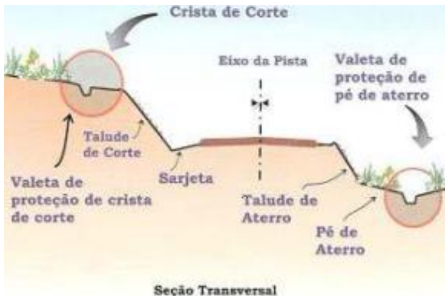
Figura 16 - Locais apropriados para instalação de valetas de proteção ao longo de estradas. Fonte: BAESSO & GONÇALVES, 2003.
