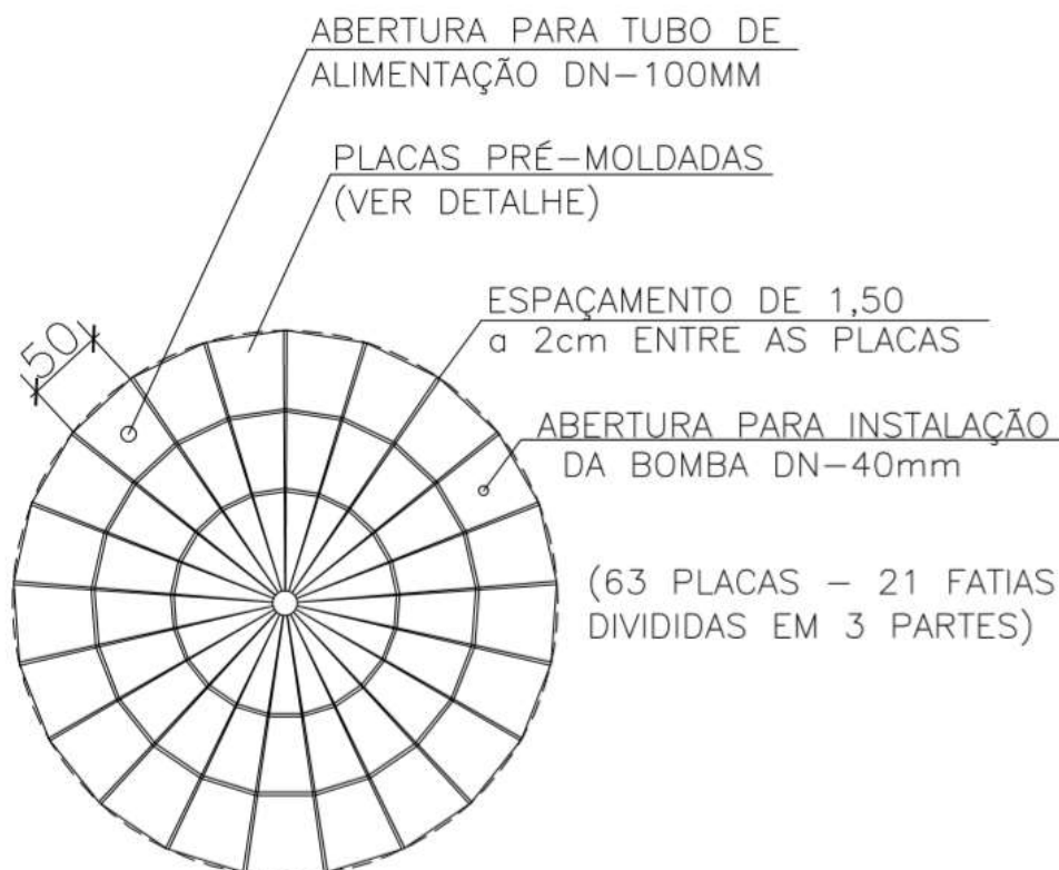
Figura 6.4 – Planta – Placas da cobertura
