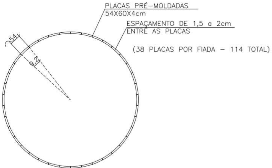
Figura 6.12 - Planta - Disposição das placas da parede
