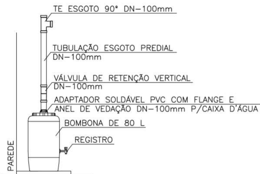
Figura 6.10 – Sistema de segurança sanitária
