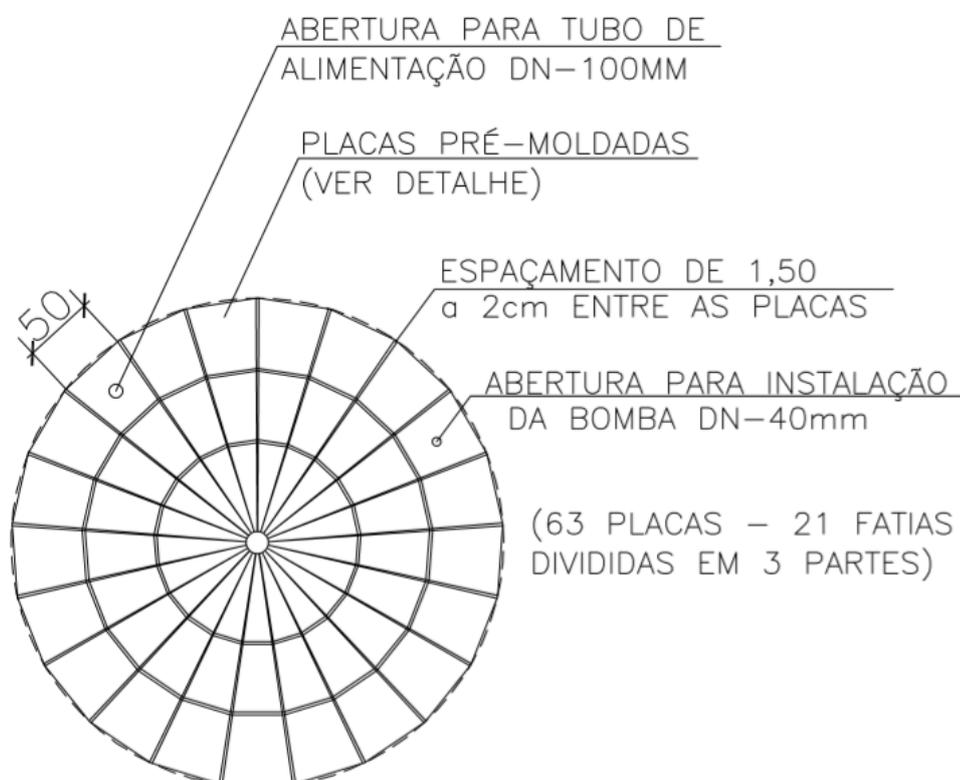
**Figura 6.4 – Planta – Placas da cobertura**
