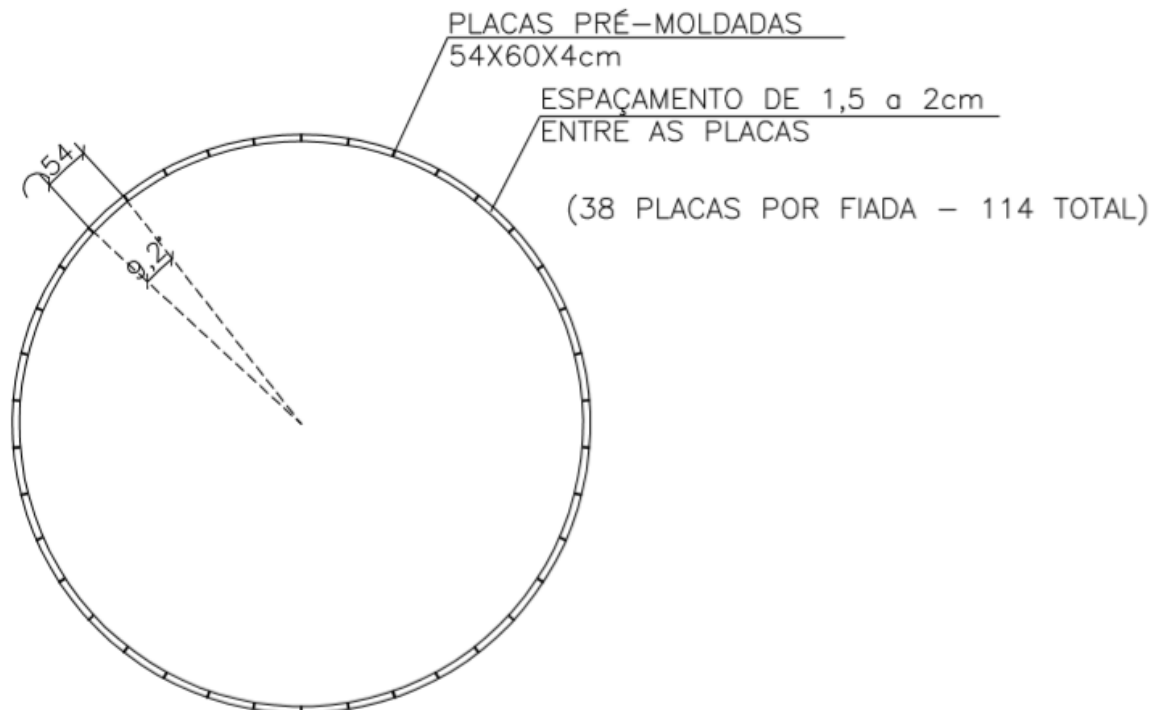
Figura 6.12 - Planta - Disposição das placas da parede
