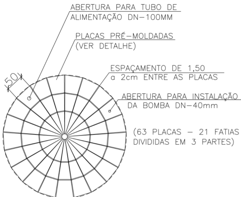
Figura 6.4 – Planta – Placas da cobertura
