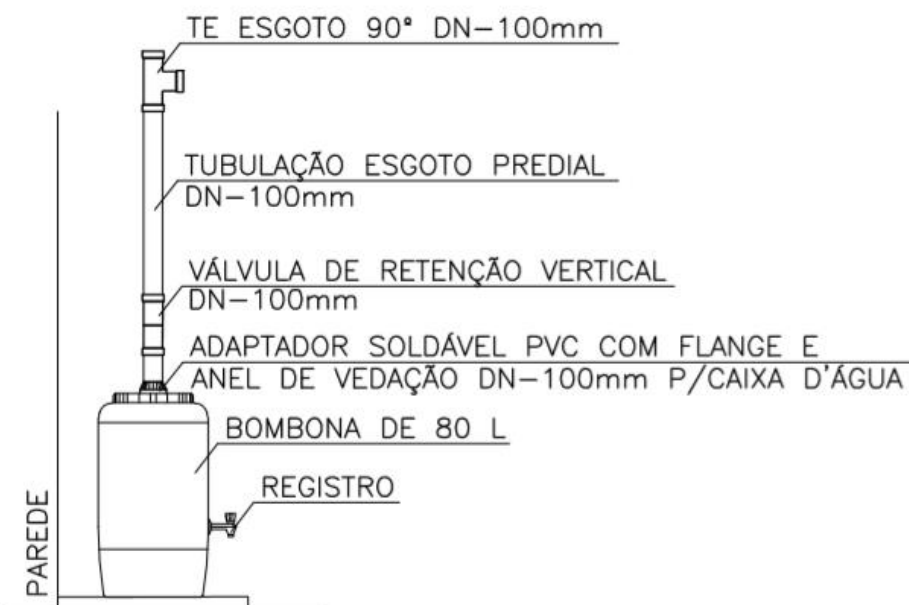
Figura 6.10 – Sistema de segurança sanitária
