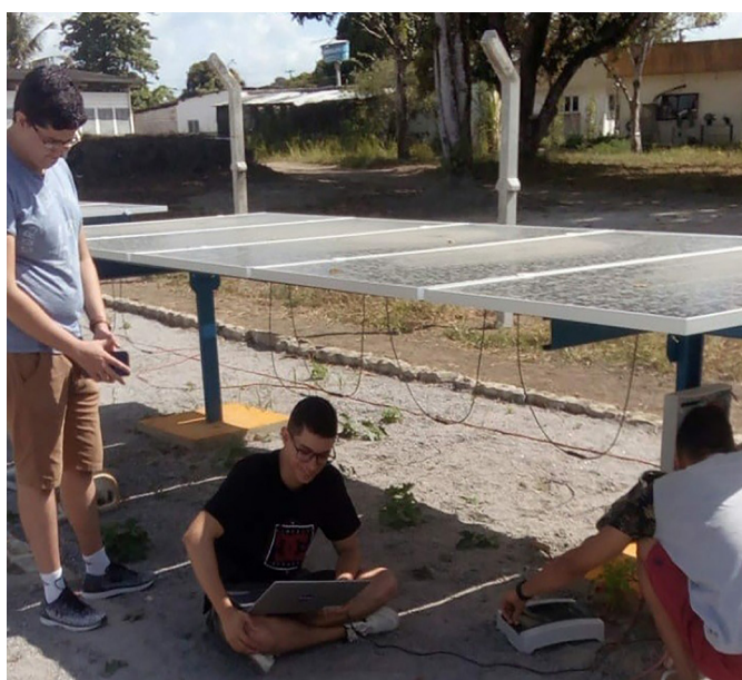
Figura 135 - Ação de avaliação do medidor (protótipo) de variáveis elétricas de um painel solar, realizada na área experimental do laboratório.
