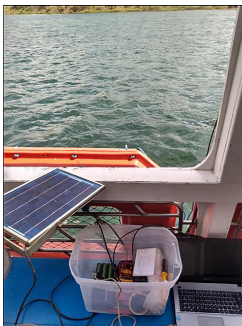
Figura 125 - Sistema de aquisição de dados instalado na embarcação da II Expedição Científica do Rio São Francisco.
