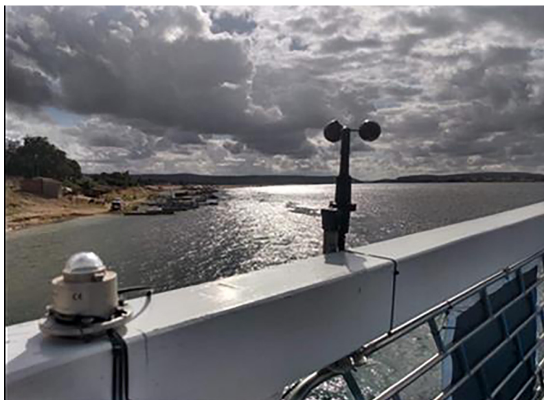
Figura 126 - Sensor de medição da radiação solar (piranômetros) e sensor de medição da velocidade do vento (anemômetro) instalados na embarcação da II Expedição Científica do Rio São Francisco.
