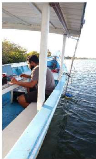
b) Suporte de inox para a fixação ao barco e posicionamento do ADCP (na água) e do GNSS.
