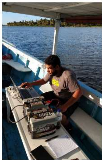
a) Notebook e duas baterias de carro em série para a alimentação do ADCP.
