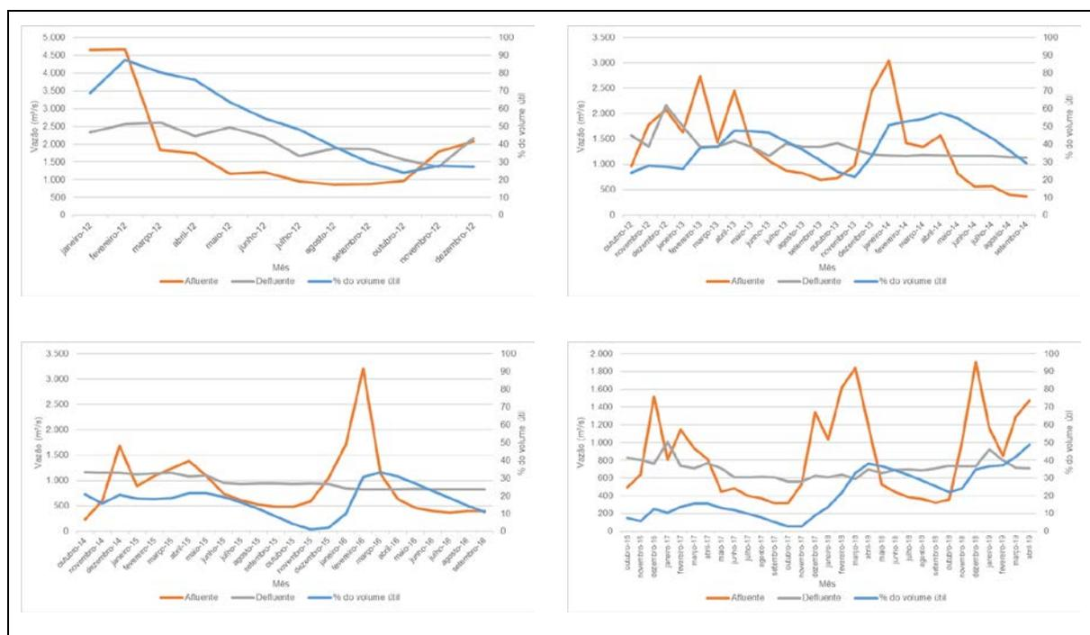
**Figura 5. Comportamento do reservatório da UHE Sobradinho nos anos de 2011 a 2019**
