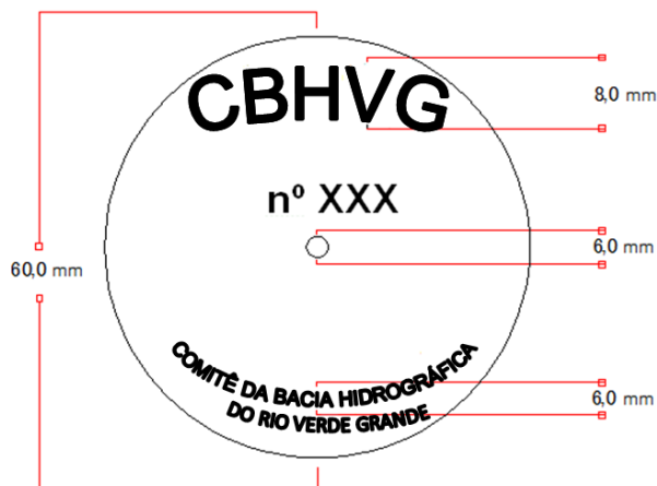
Figura 12: Corte e vista da plaqueta metálica.
