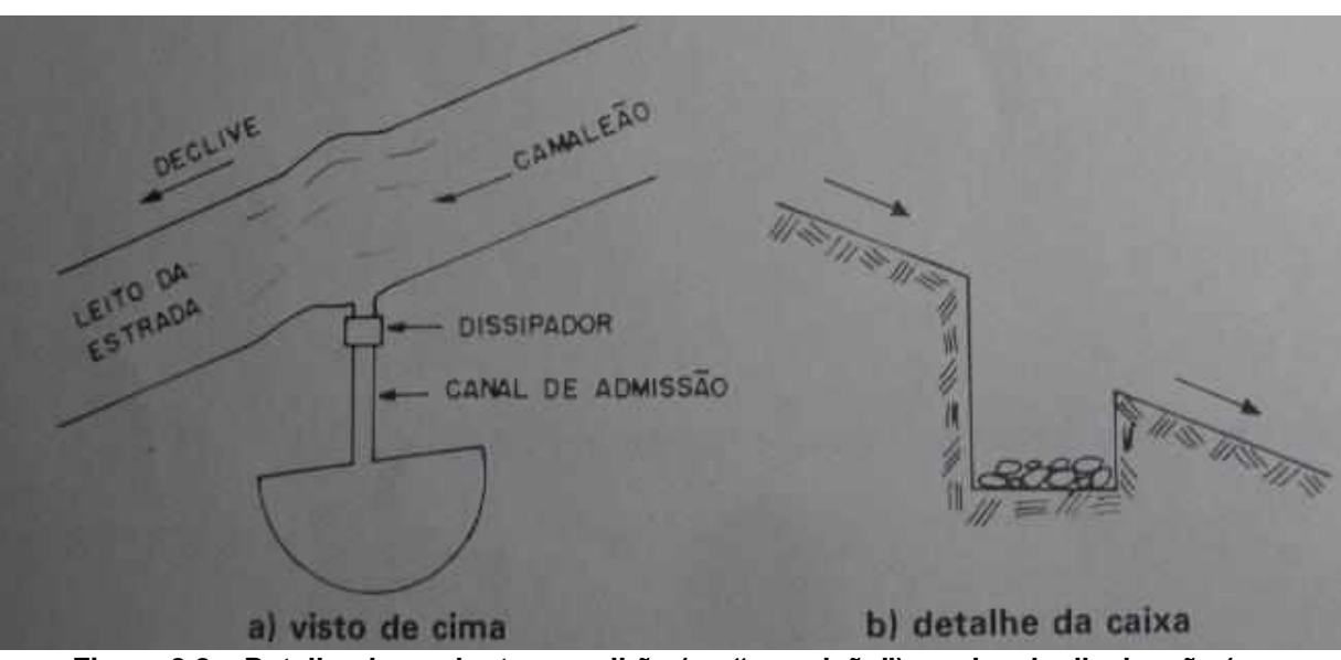
Figura 8.8 – Detalhe do conjunto camalhão (ou “camaleão”) + caixa de dissipação (ou “dissipador”) + canal de admissão (detalhe em “b”) + bacia de retenção Fonte: BELLINAZZI et al. (1989)
