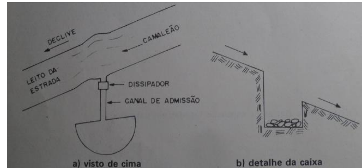
Figura 4.6 – Detalhe do conjunto camalhão (ou "camaleão") + caixa de dissipação (ou "dissipador") + canal de admissão (detalhe em "b") + bacia de retenção Fonte: BELLINAZZI et al. (1989)
