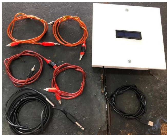
Figura 4. Ambiente experimental para medição dos parâmetros elétrico de gerador fotovoltaico.
