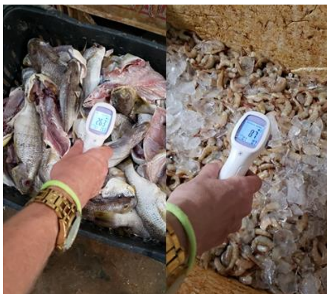
Figura 16 – Mensuração da temperatura do pescado com termômetro infravermelho.
