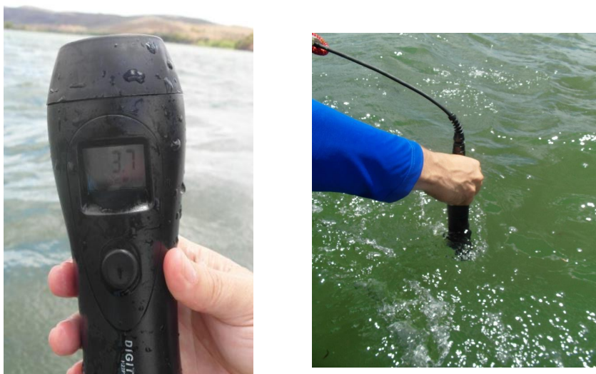
Figura 2. Aferição da profundidade e do total de sólidos dissolvidos durante a II Expedição do Baixo Rio São Francisco em novembro de 2019.
