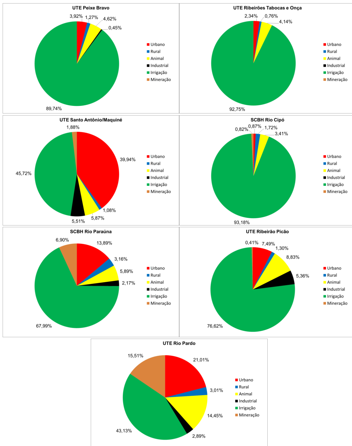
FIGURA 30: PROPORÇÕES DAS VAZÕES MÉDIAS DE RETIRADA ASSOCIADAS A CADA SEGMENTO USUÁRIO DE ÁGUA NAS UTEs DA REGIÃO MÉDIO BAIXO RIO DAS VELHAS – CAPTAÇÕES SUPERFICIAIS E SUBTERRÂNEAS.
