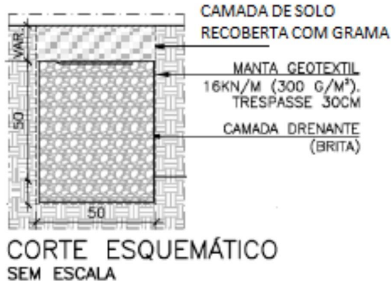
Figura 7 - Corte Esquemático do dreno cego Fonte: Adaptado SUDECAP (2019)
