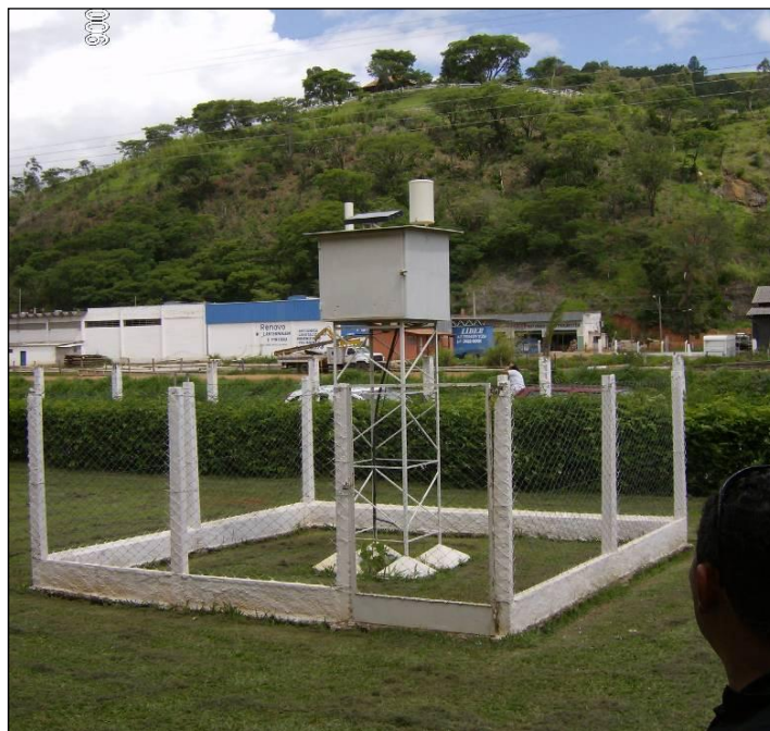
Figura 6 – Estação Telemétrica ou Automática
