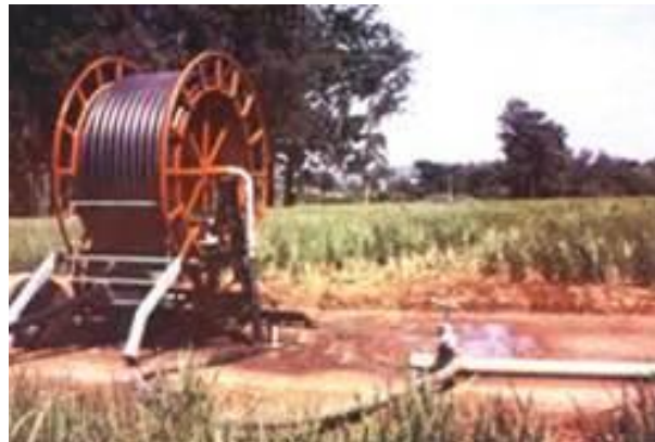
Figura 72 – Mangueira sendo enrolada pelo carretel
