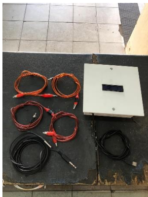
Analizador de baixo custo desenvolvido em laboratório
