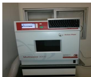
Digestão ácida em micro-ondas
