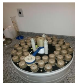
Digestão ácida em micro-ondas
