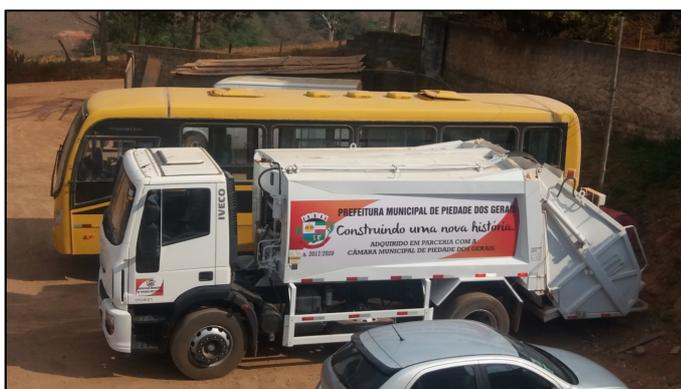
Figura 37: Caminhão compactador utilizado na coleta convencional
