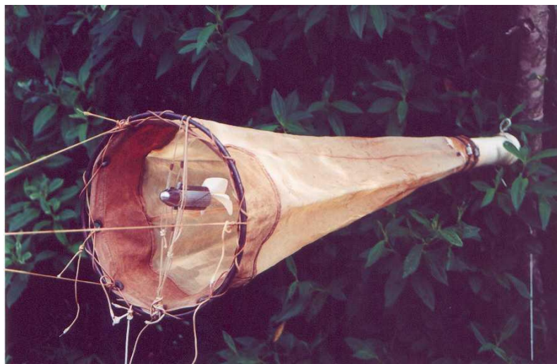
Figura 11 – Rede de ictioplâncton equipada com fluxômetro.
