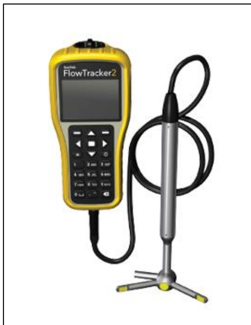
Figura 21- Medidor de vazão portátil.
