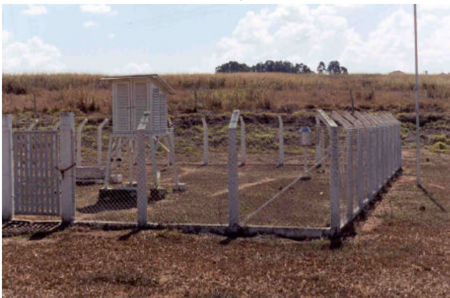
Foto 1. Exemplo de uma estação pluviométrica do tipo PrEC
