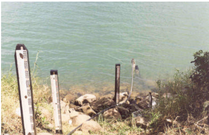
Foto 2. Exemplo de uma estação fluviométrica do tipo FRDSQT Fonte: Arquivo do Consultor, Setembro de 2002
