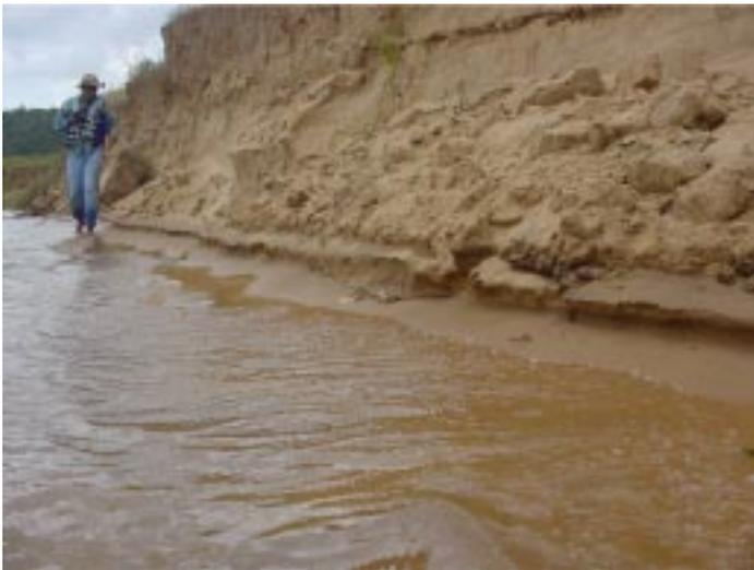
**Foto 7. A foto registra a ação das ondas, durante elevação artificial do nível do rio. Margem do rio São Francisco, próximo a Gararu. Dia 13/09/01.**
