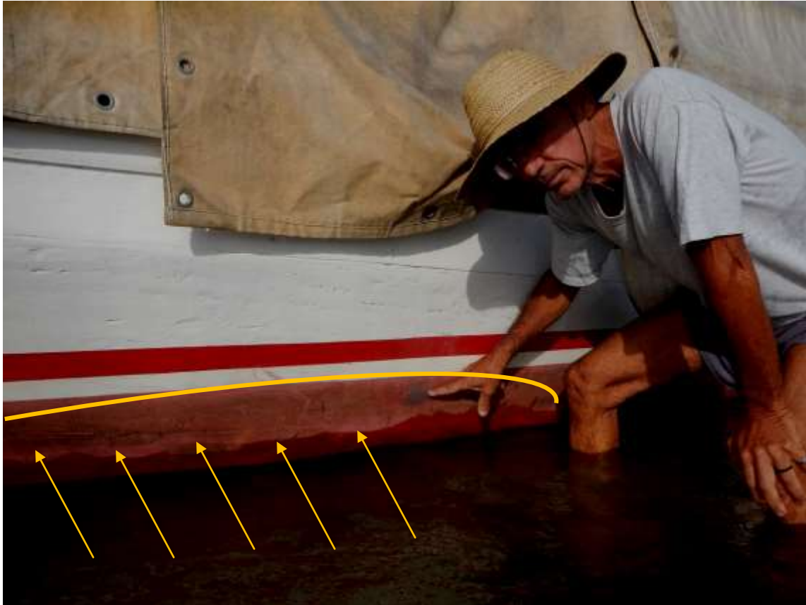
Figura 17 - Em diversos pontos a tinta foi completamente removida, expondo a base do casco.
