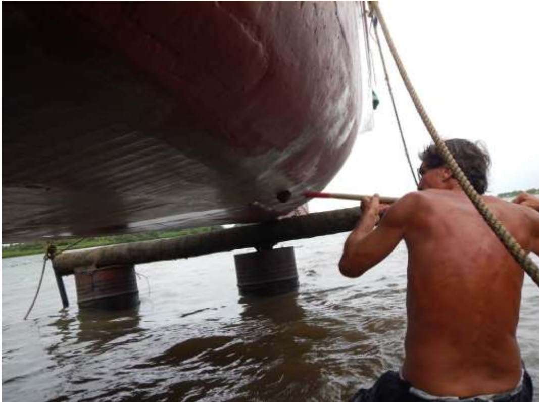
Figura 9 - Aplicando a tinta antiincrustante no fundo.
