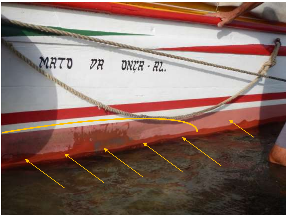
Figura 18 - Praticamente toda a bochecha de boreste foi danificada, além do fundo do casco.
