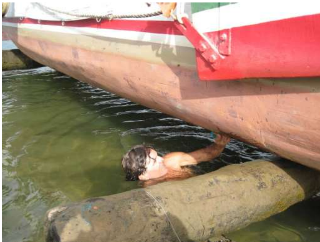
Figura 7 - Ainda com o casco molhado, a remoção de sujeira, organismos aderentes, lodo, etc.
