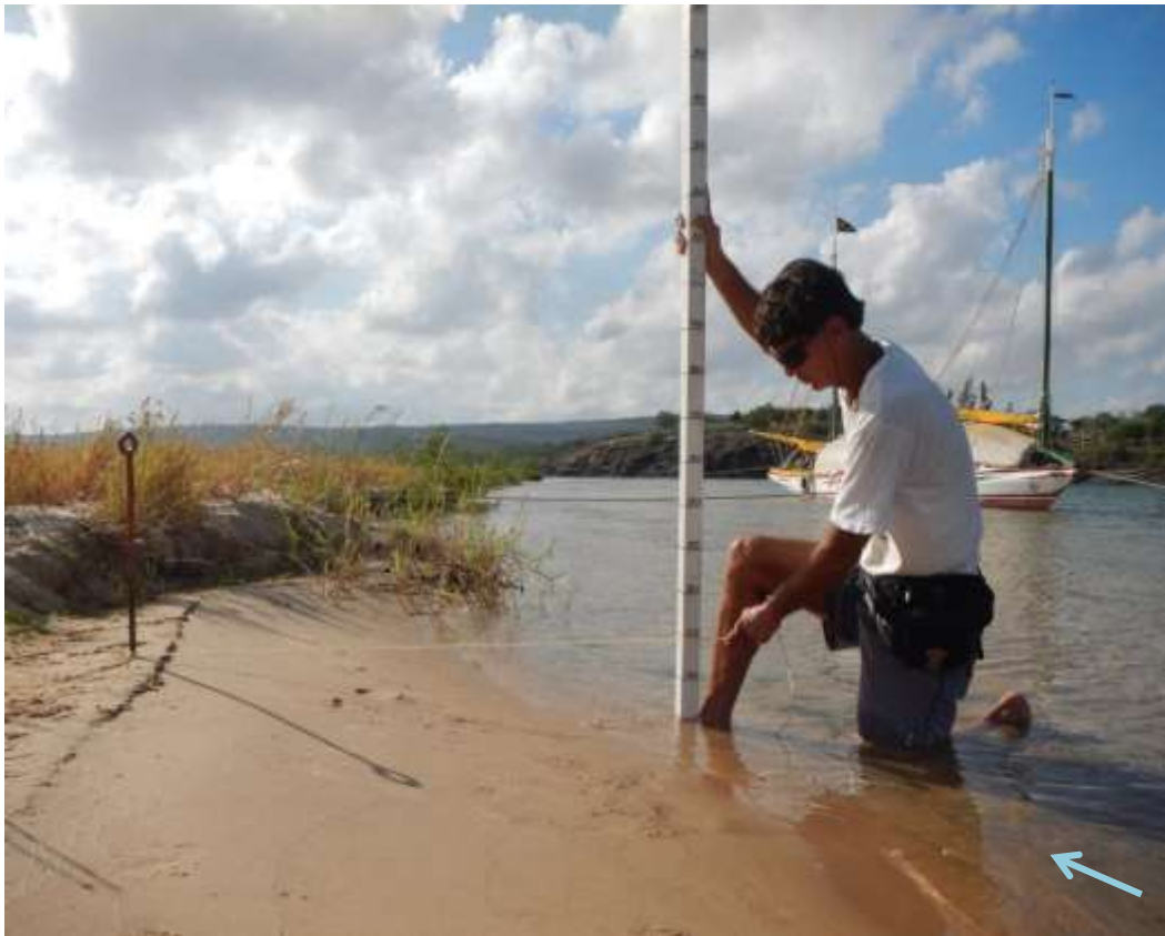
Figura 84 – Na manhã do dia 8, a medição da comprovação da grande variação de nível que é um dos grandes flagelos no Baixo São Francisco (cerca de 190 mm em Gararu).
