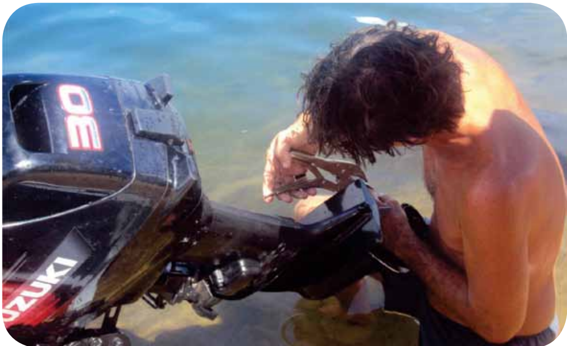
Figura 114 - Reparo de hélice após impacto em pedra.
