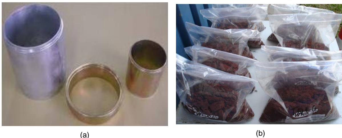
Figura 8.1 – Coleta e acondicionamento de amostras indeformadas (a); Acondicionamento de amostras deformadas (b)
