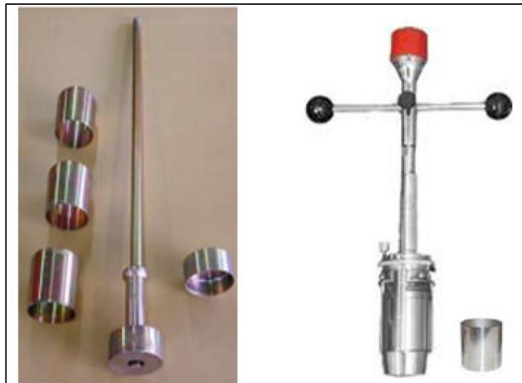
Figura 8.2 – Equipamentos utilizados para coleta de amostra indeformada
