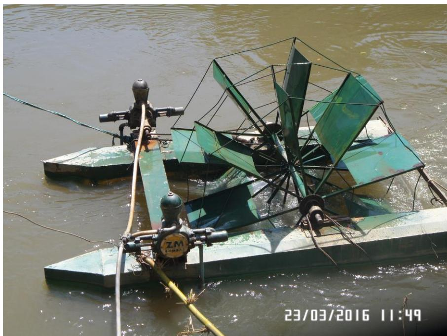
**Figura 7.1 – Roda d'água**
