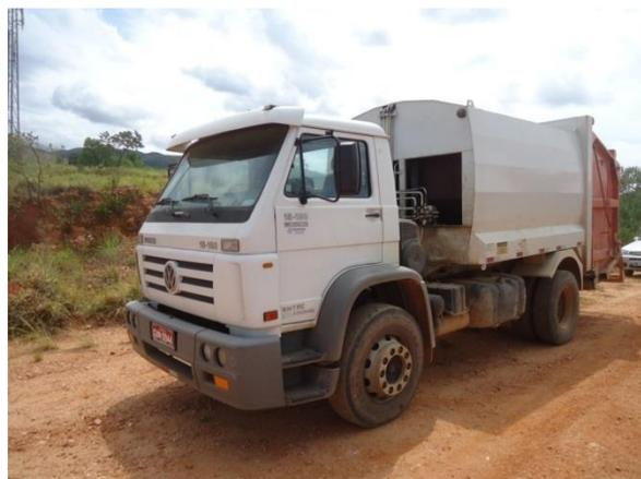
Figura 4.8 – Caminhão compactador terceirizado utilizado na coleta de resíduos sólidos em Santana do Riacho
