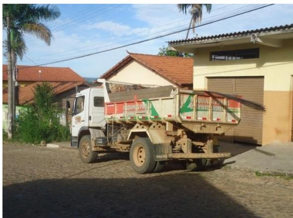
**Figura 4.11 – Caminhão basculante da Prefeitura utilizado para a remoção dos resíduos da LPU**
