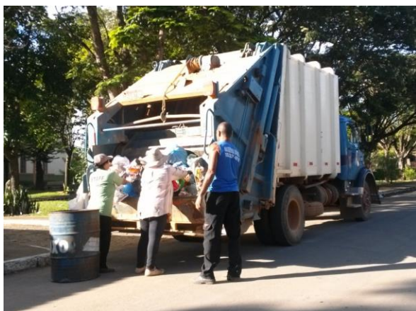
Figura 4.12 – Equipe de coleta acomodando os resíduos dentro do caminhão (Prensa em funcionamento) Fonte: COBRAPE (2014)
