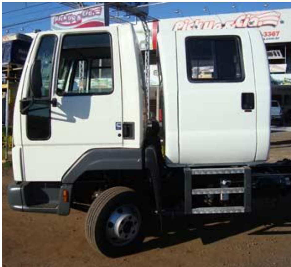
Figura 8.7 – Exemplo de módulo auxiliar para transporte de funcionários adaptado em caminhão
