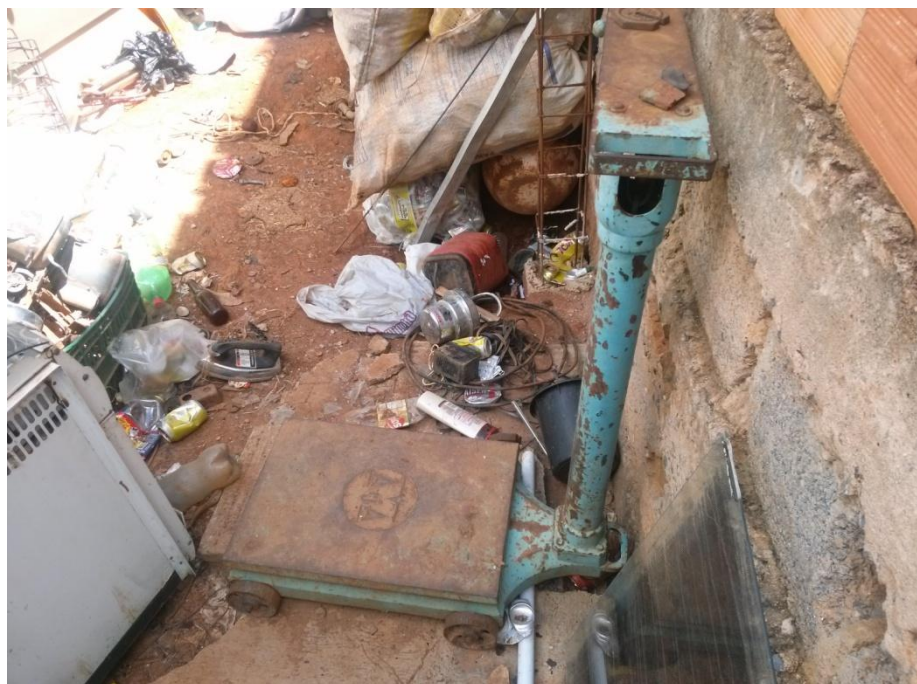
Figura 7.178 – Balança para pesagem de resíduos comprados
