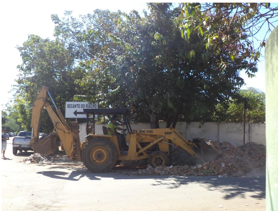
Figura 7.155 – Retroescavadeira utilizada na coleta de entulho
