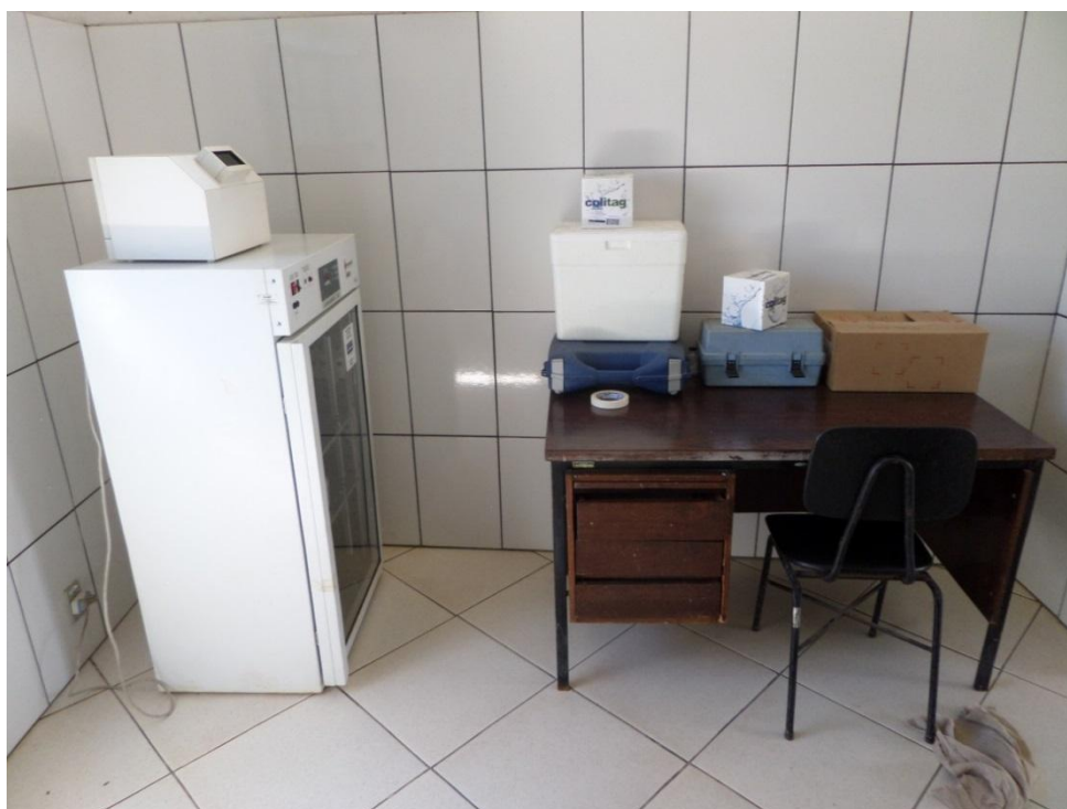
Figura 7.92 – Detalhe para a estufa para realização das análises microbiológicas da água
