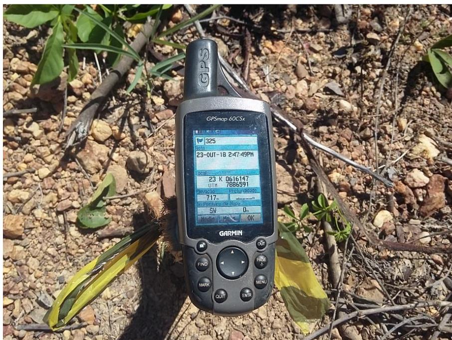
**Figura 6.1 – GPS Utilizado no levantamento topográfico**
